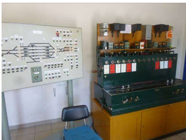
Obrázek 5: Řídící přístroj elektromechanického zabezpečovacího zařízení (vpravo) a přídavný hradlový přístroj zajišťující vzájemné vazby mezi SZZ a TZZ směr Slavkov u Brna (vlevo) v ŽST Bučovice
